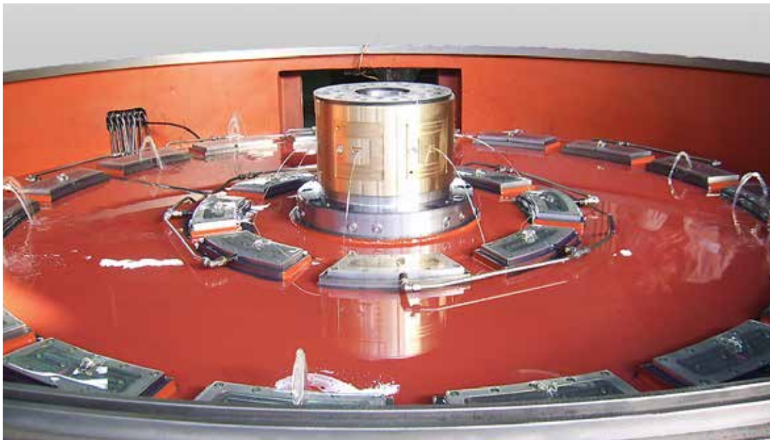
直径 \varnothing 4.000 mm的转台轴承套件
