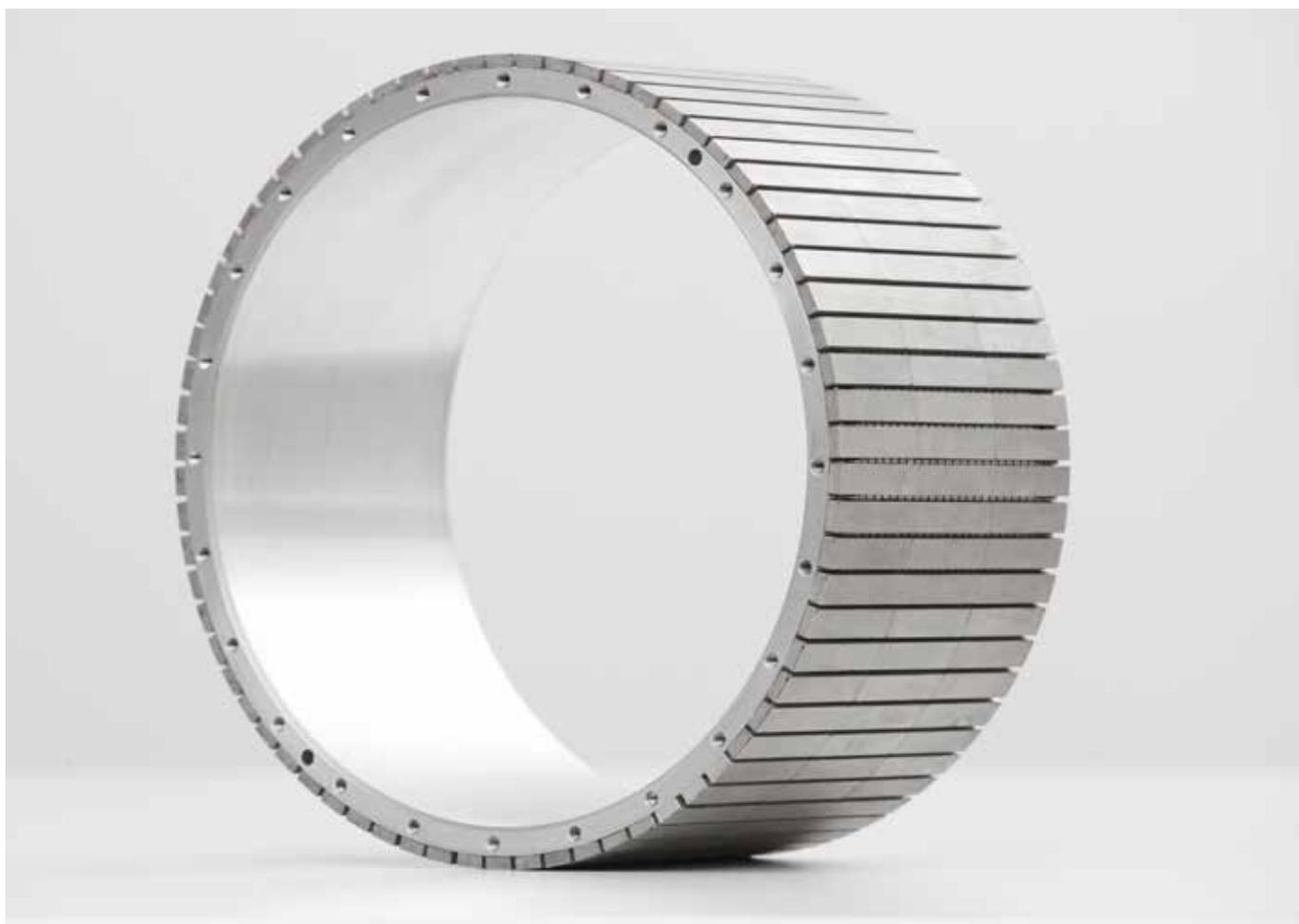
卓轮力矩电机是高精度无框电机，由绕线定子和永磁体转子组成，低速大扭矩的电机，具有能效高，高可控性，低磨损维护少，没有齿隙等特性。产品系列最大直径2.500 mm和最大输出扭矩58.000 Nm。
