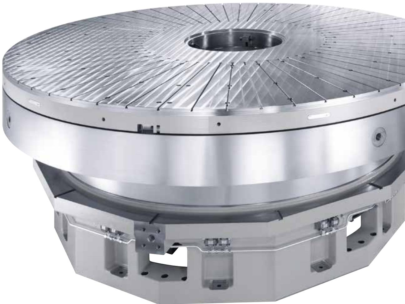
GRT磨削转台适用单立柱或龙门立式圆柱磨床。转台与床身集成为一体。无齿隙直驱力矩电机确保转台平稳转动。液体静压支承设计为径向和轴向双向支承。GRT磨削转台具有优异的阻尼效果和长使用寿命。。
