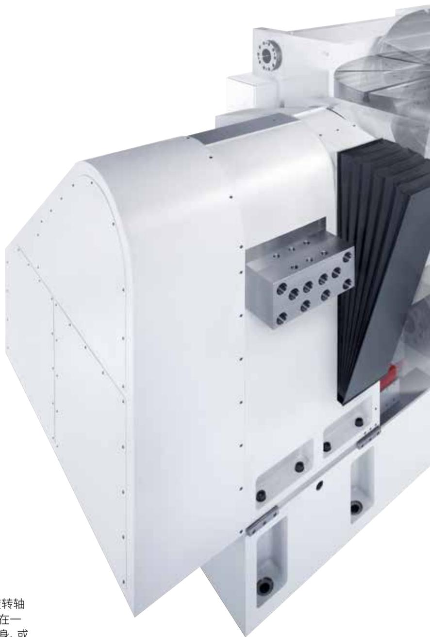
摇篮式转台是旋转轴和摇摆轴组合在一起。旋转轴和摇摆轴模块都选自MRT铣削转台系列，组合在一起满足客户应用需求。摇篮式转台可集成于床身，或配合滑动线性轴安装于客户床身上。转台工件夹紧装置、加工范围等特性，结合托盘快换系统、线性轴等整体设计，为客户提供最优化方案。
