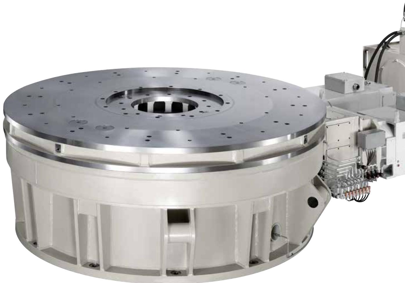
卓轮-Rückle TRT车削转台系列适用于立式车床和铣床。按不同应用场景，TRT转台可设计为集成旋转轴、独立一体或组合线性轴安装等多种形式。TRT 400到 TRT 1000选择直驱力矩电机，TRT 1000到 TRT 4000 选择主仆控制机制，这些技术确保转台高精度定位和连续动作优异可控制性。可定制线性轴与TRT转台组合在一起。
